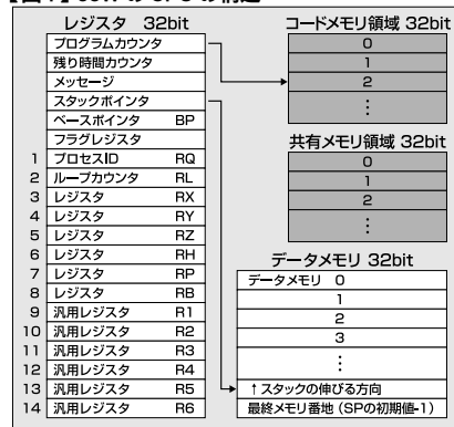
【図1】J3WのCPUの構造
